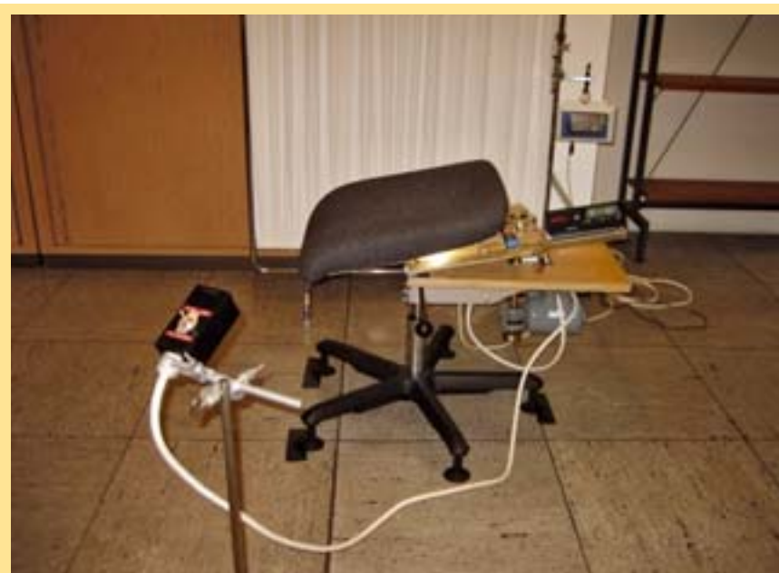
Abb. 4: Versuchsträger mit elektromotorischem Antrieb. Die Gleiter wurden gegen Verrutschen mit Klebeband fixiert. Eine Metallschiene zwischen der Basis des Versuchsträgers und der Wand verhinderte eine Drehbewegung der Sitzfläche.
