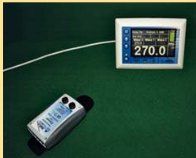
Abb. 2: Digitaler Winkelmesser der Firma Thumedi, Thum-Jahnsbach. Messwertgeber mit integriertem Bluetooth-Modul, Lilon-Akku und 3D-Winkelsensor; Anzeigeeinheit für Winkel-Fernmessung mit integriertem Bluetooth-Modul.
