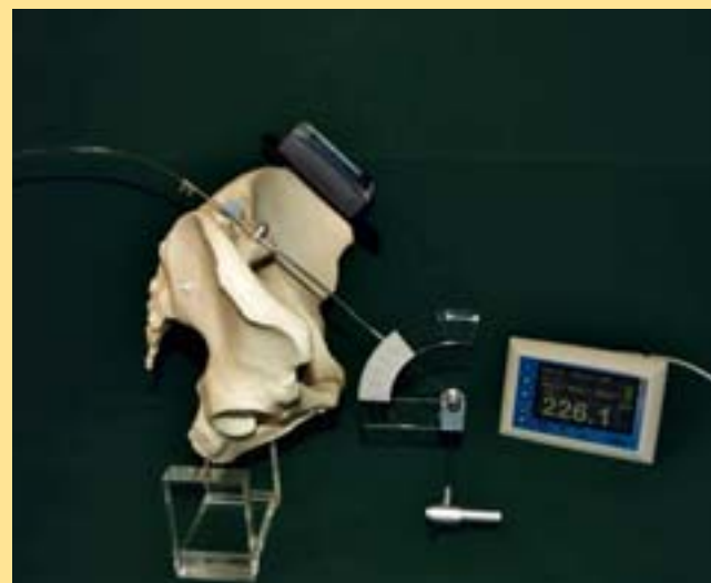
Abb. 3: Digitaler Winkelmesser am anatomischen Modell des knöchernen Beckens
